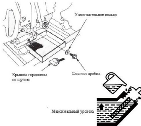
Перед тем, как сливать масло, дайте двигателю немного остыть. Избегайте продолжительного или повторяющегося контакта отработанного масла с кожей. Оно канцерогенно. Тщательно промывайте кожу водой с мылом после контакта с отработанным маслом и пользуйтесь защитными кремами.
